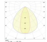
**Caractéristiques Module 70W 11200lm 30D - 840 Blanc Froid | 1500mm - 8-pole**
