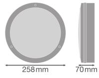
**Caractéristiques Ledvance Surface Bulkhead 250 10W 840 800lm Blanc IP65**
