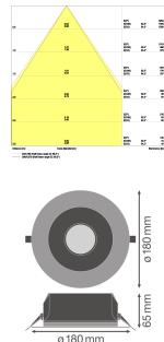
**Caractéristiques Ledvance Spot encastrable LED Performance DN155 14W 1500lm 65D - 830 | 180mm - IP54 - Dali Dimmable**
