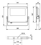
**Technische Daten Philips Led-Scheinwerfer BVP125 Coreline 116W 16000lm 40x21D - 740 Kaltweiß | IP66 - Asymmetrisch**
