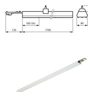
Technische Daten Philips LED Tragschiene Coreline
