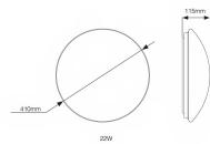
**Technische Daten LED-Wand- und Deckenleuchte Weiß 22W 1839lm - 830 | 410mm - IP44**
