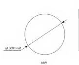
**Technische Daten LED-Wand- und Deckenleuchte Weiß 18W 1386lm - 830 | 360mm - IP44**
