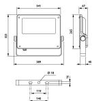
**Technische Daten Philips LED-Scheinwerfer Coreline BVP125 Grau 66W 8200lm 9-41x102D - 740 | IP66 - Asymmetrisch**
