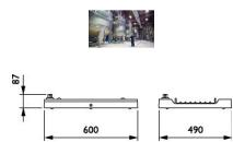
Technische Daten Philips LED-Highbay GentleSpace BY481P 232W 35000lm 44D - 840 | IP65
