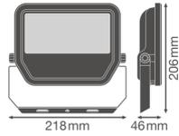
Technische Daten Ledvance LED-Scheinwerfer GEN 3 Schwarz 50W 5500lm 100D - 830 | IP65 - Symmetrisch - Ersatz für 100W
